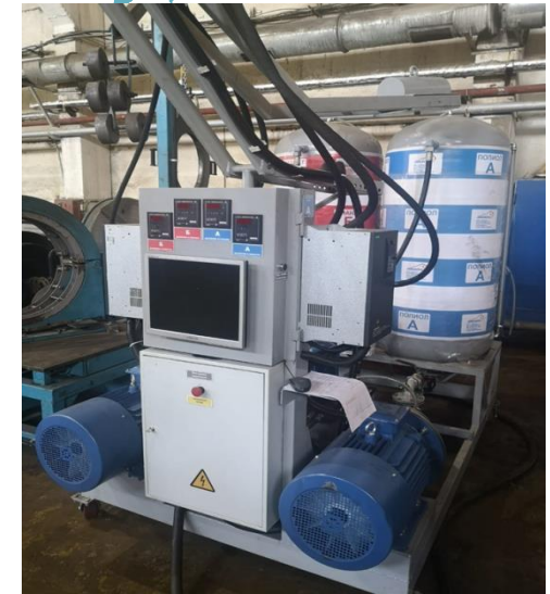
п.2.3. Пенозаливочная машина для заливки фасонных изделий
